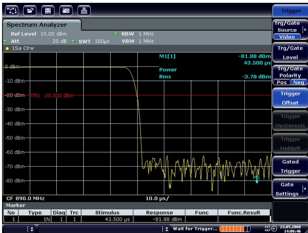
図 6-10: 時間分解能を上げて GSM バーストの立ち下がりエッジを表示
